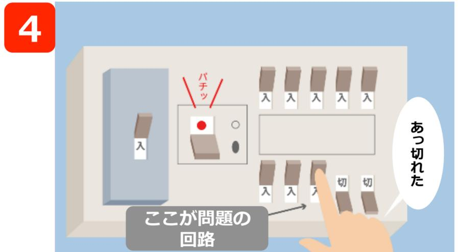
問題のある回路の配線用遮断器を入れた時に漏電遮断器が切れたらその回路に漏電の可能性がある
