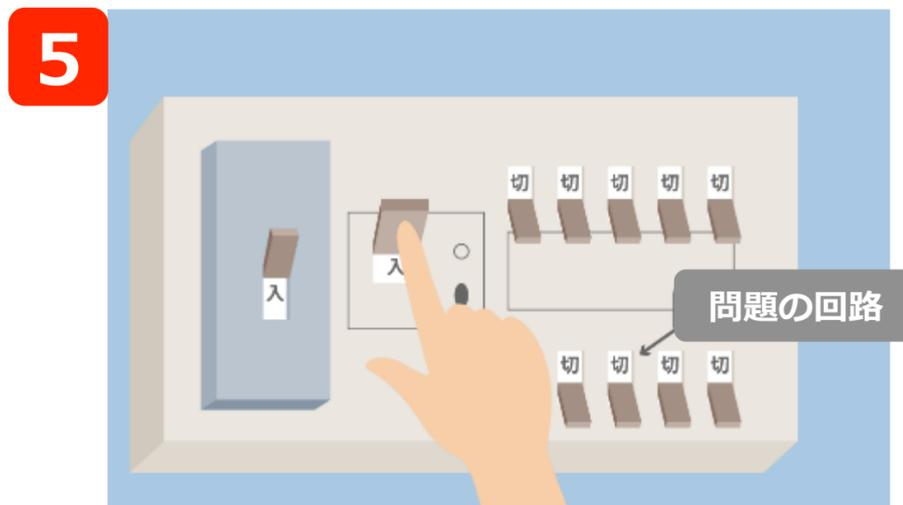
すべての配線用遮断器を「切」にし、再び漏電遮断器のつまみを入れる
