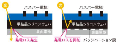
\* PERC (Passivated Emitter and Rear Cell) 構造とは、パッシベーション膜という絶縁体により、セルの裏面をコーティングし、その絶縁体層が光を反射させることで、ロスを軽減し、太陽電池モジュールの変換効率を向上させています。
