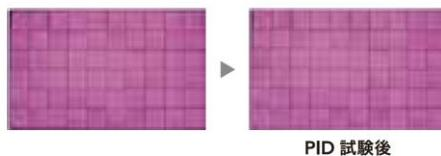
正常な場合、上図のように発光しますが、劣化が進むと暗部が多くなり最終的には発光しなくなります。
